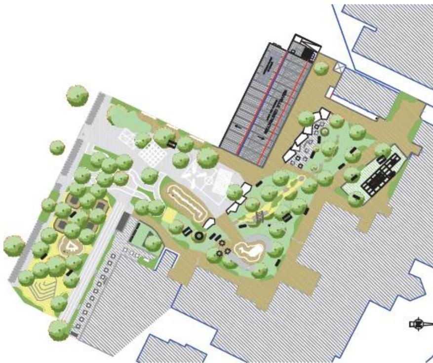
Sur une surface opérationnelle de 6600 m<sup>2</sup>, le projet prévoit une désimperméabilisation à 100% de la surface, une déminéralisation à 28%<sup>14</sup> et la végétalisation de 22% avec la plantation de 30 arbres. L'élément important de cette nouvelle cour est l'extension de la surface disponible de la partie sud de la cour : « nous on s'était dit on va récupérer juste l'allée qui est devant
